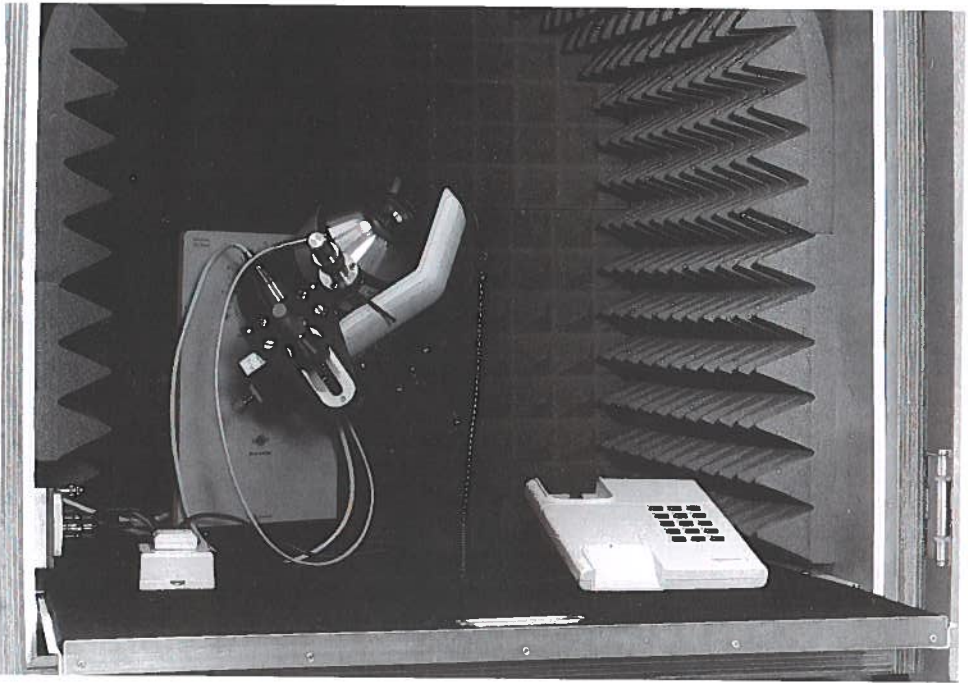
▲ Foto 2 Apparaat waarmee telefoonhoorns worden getest.
